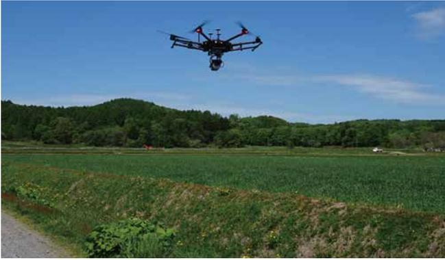
写真-5 UAVレーザ計測状況
