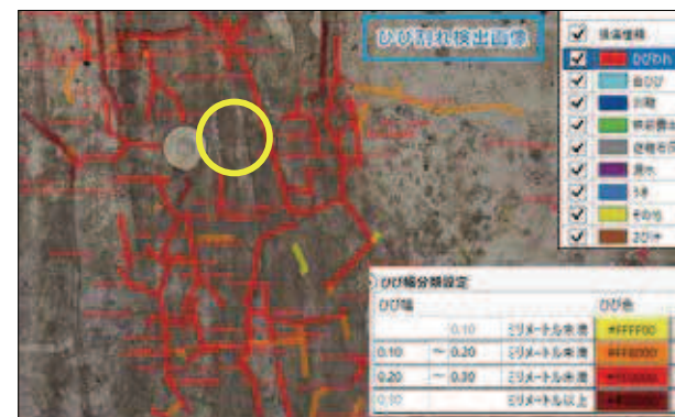
写真-9 ケース4の画像解析結果(ひび割れ表示)
