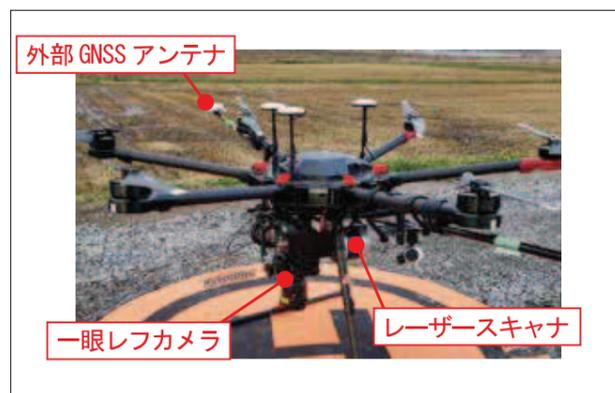
図-1 UAV搭載型レーザシステムの装着状況
