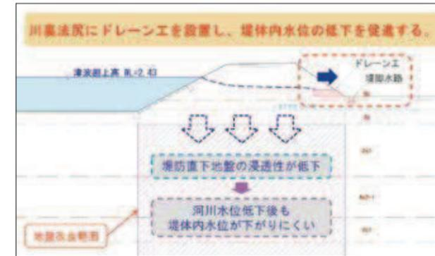
図-9 ドレーン工・堤脚水路
